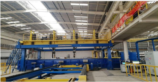
▲ 水浸式超声波无损探伤设备
